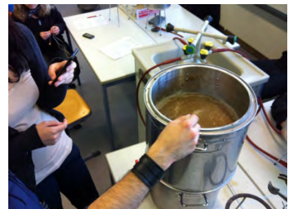
Abbildung 9: Das Abläutern mit Hilfe eines kleinen Läuterbottichs.
